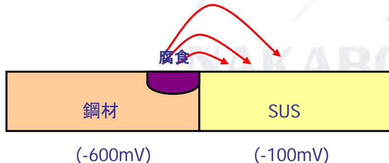
\* 金属材料の材質の違いによる電位差を起電力として腐食電池が形成
