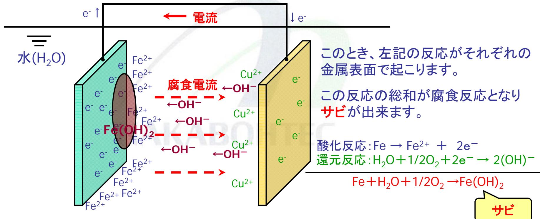
酸化反応/アノード反応:  $Fe \rightarrow Fe^{2+} + 2e^-$
