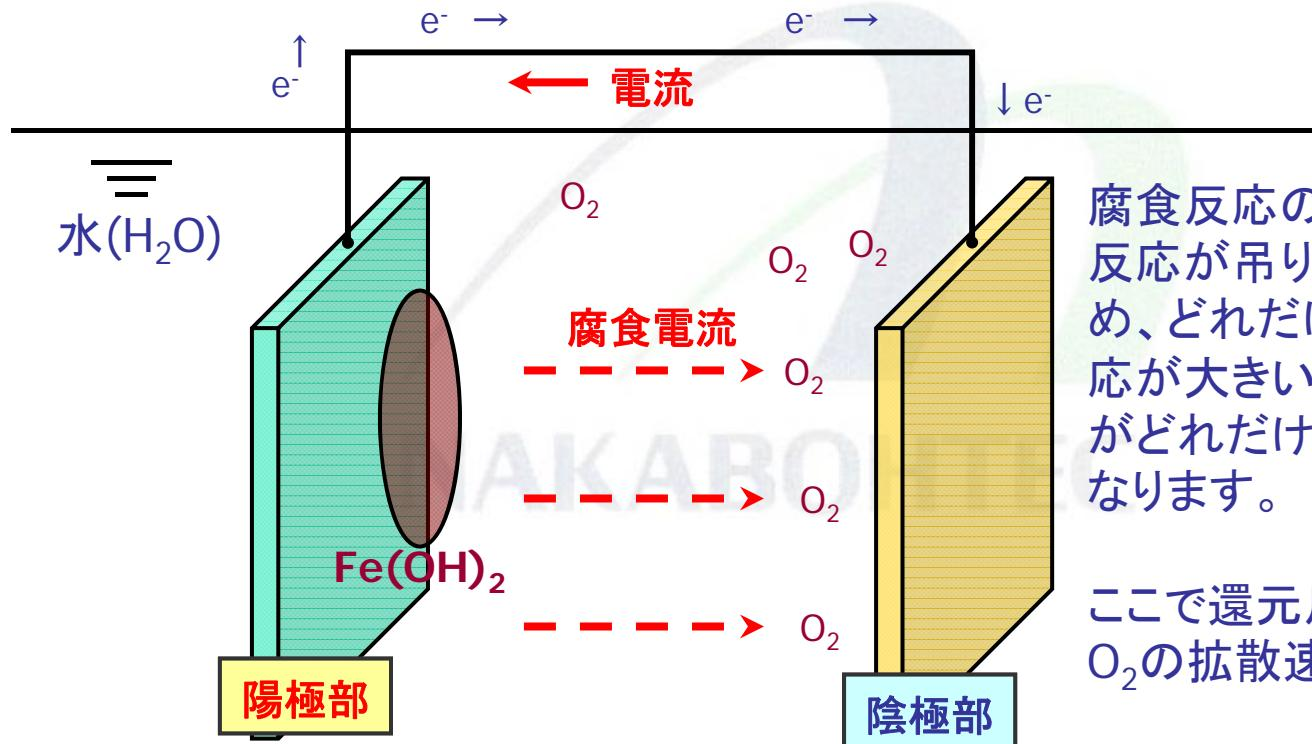
腐食反応の大きさは酸化反応と還元反応が吊り合った速度で進行するため、どれだけ、Feが溶解する酸化反応が大きいか？ではなく、還元反応がどれだけ進行するか？が支配的となります。
