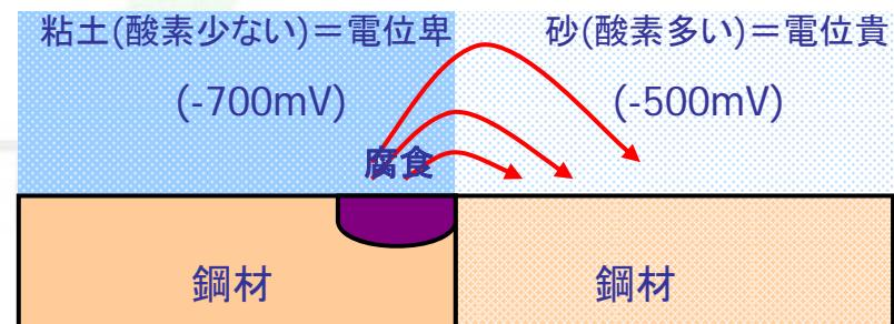
\* 酸素の濃淡による電位差を起電力として腐食電池が形成
