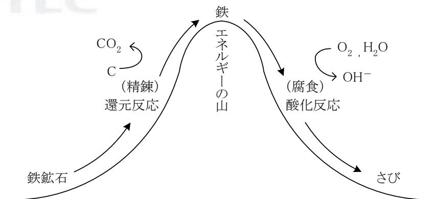
図1 鉄鉱石からさびへの変化
