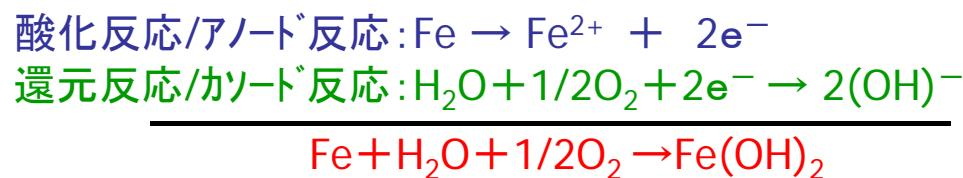
$\text{O}_2$  の拡散速度に律速される
